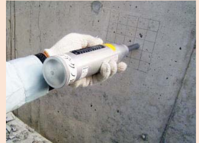
シュミットハンマー (コンクリート強度試験)
