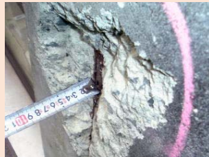
蛍光エポキシ樹脂による コンクリートコアサンプル (コア寸法φ50×900)
