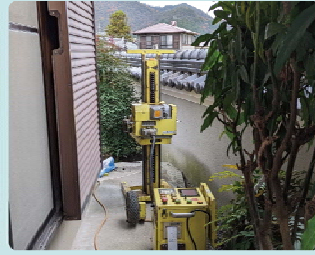
スウェーデン式 サウンディング試験
