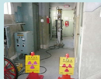
X線検査 (埋没物調査)
