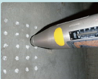
シュミットハンマー (コンクリート強度試験)
