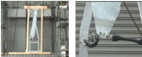
【1/30 変形時の状態】 大きな変位にも耐えて揺れを押えます。QT ダンパーは建物の変形を 1/30 以下にすることを目的としています。
