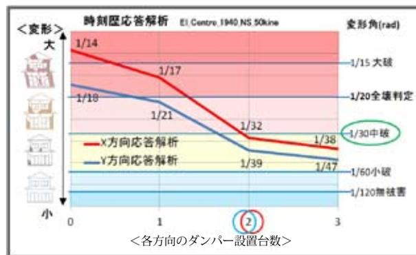
① Q Tダンパーを使用することで、大地震時での建物の変形を半分以上にすることが出来ます。
