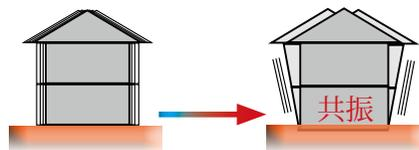
木造建物が地震動を受けると、柱と梁の接合部が損傷を受け緩みが生じます。木造建物は緩むことにより固有周期が伸びて、周期で1~2秒の「やや短周期地震動」(キラーパルス)と共振してしまい、大きな揺れとなり倒壊に至ると言われています。Q Tダンパーの持つ制振性能が建物の緩みを抑えて、キラーパルスとの共振を防止します。
