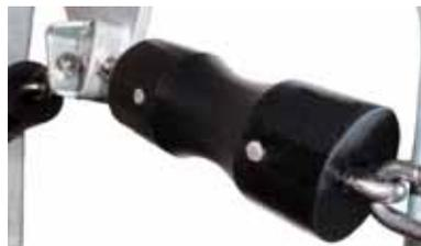
QTダンパーに使用する高減衰ゴム（ゴムチェーンダンパー）の中央部と、チェーン埋め込み部の断面積の差により、中央部の高減衰ゴムに応力が集中し、効果的に制振機能を発揮できるように開発された高性能ダンパーです。
