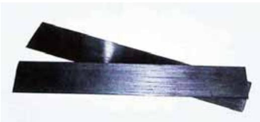
① CFラミネートは高強度 (T700S)、もしくは高弾性 (M46J) の炭素繊維を一方向に引き揃え、熱硬化型のエポキシ樹脂を含浸させた炭素繊維強化型プラスチック (CFRP) 硬化板です。
